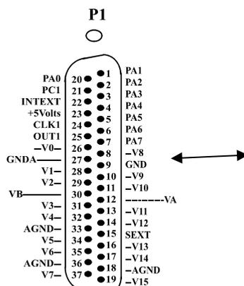
Brochage du connecteur mâle de liaison à la station d'acquisition. (Sub-D 37 points mâle)
